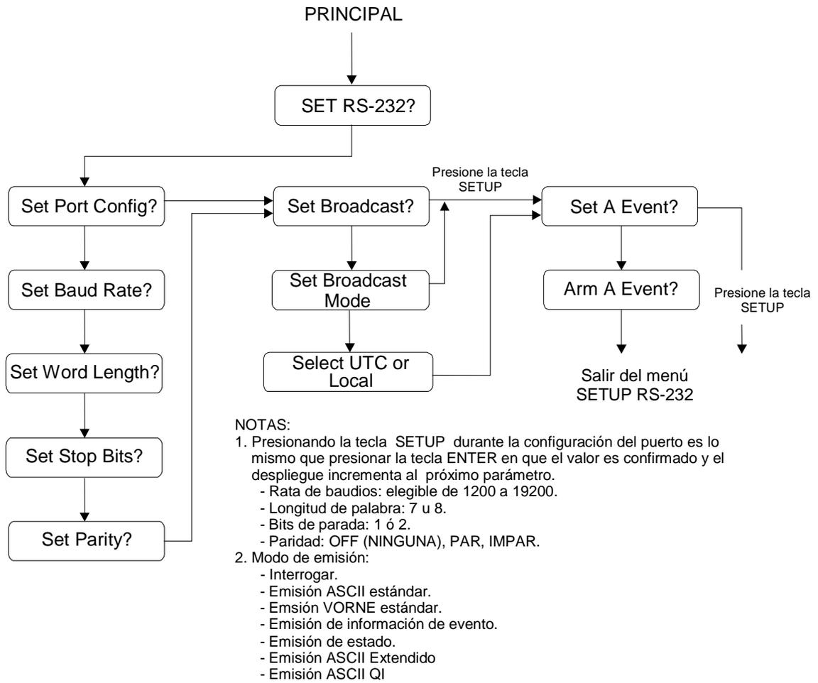
**Figura 5-1. Diagrama de flujo del menú de ajuste de RS-232**
