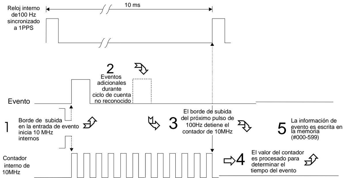
**Figure 4-6. Principio de medición del tiempo de evento**
