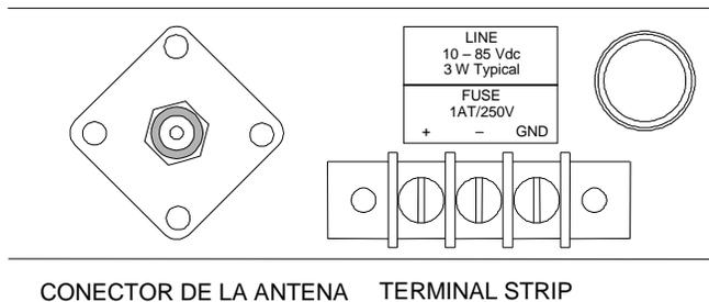
**Figura 3-3. Terminal strip con la fuente de poder de 10 – 85 Vdc de la opción 08**
